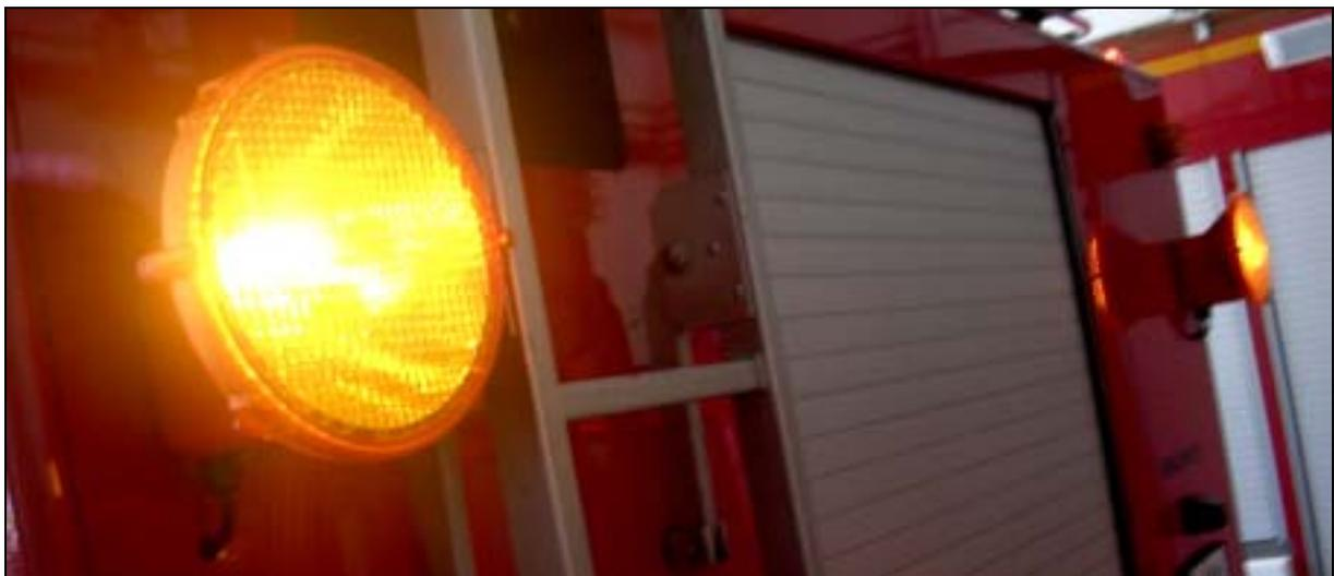
Endlich ein kleiner Erfolg: Im Jahr 2006 montierte die Werkstatt der Branddirektion auf der Feuerwache 9 zwei Heckblitzer zur wirksamen Verkehrsabsicherung.
