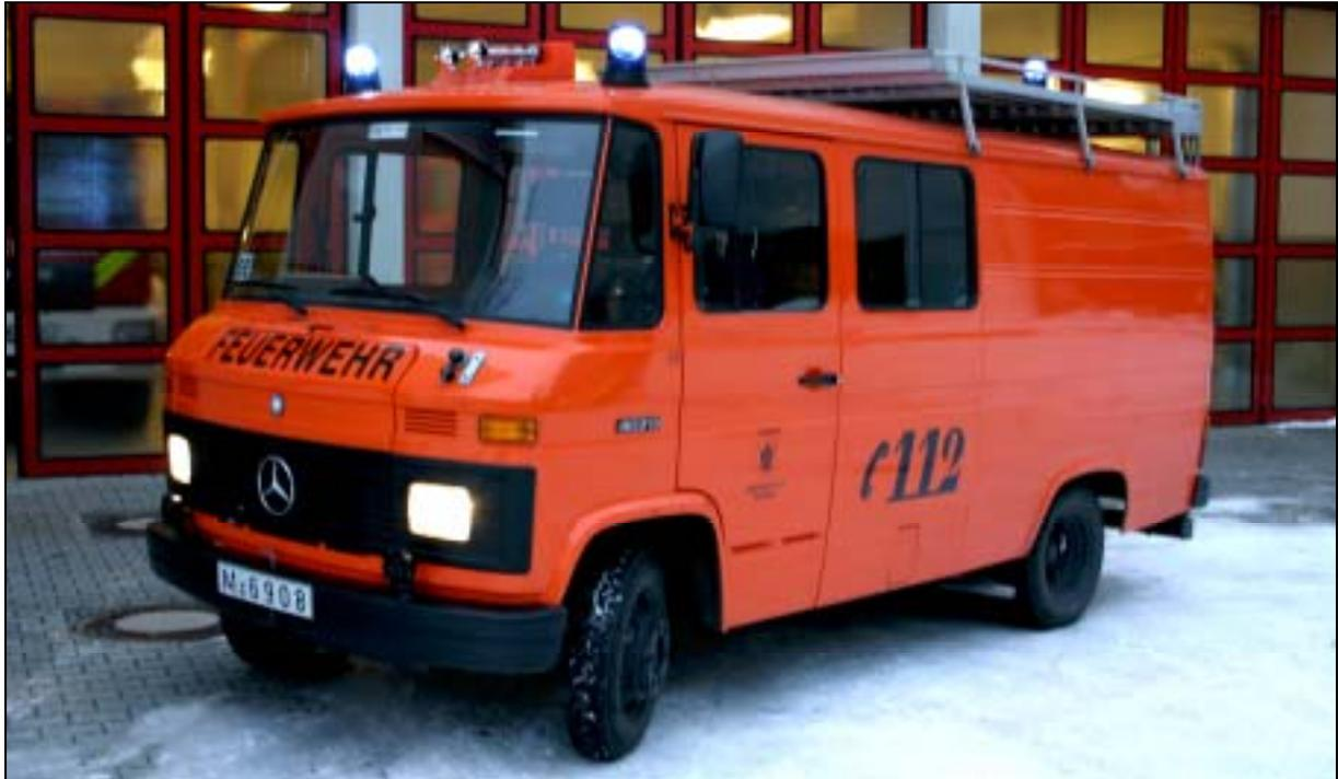
Neben der üblichen Funkausstattung für Feuerwehrfahrzeuge ist der Fernsprechkraftwagen vor allen Dingen mit Material und Ausrüstung zum Aufbau und Betrieb von Feldtelefonverbindungen im Katastrophenfall oder bei Großschadensereignissen ausgerüstet. Bei der Abteilung Sendling wird dieses Fahrzeug vorwiegend als Zubringerfahrzeug für die luK-Gruppe eingesetzt.
