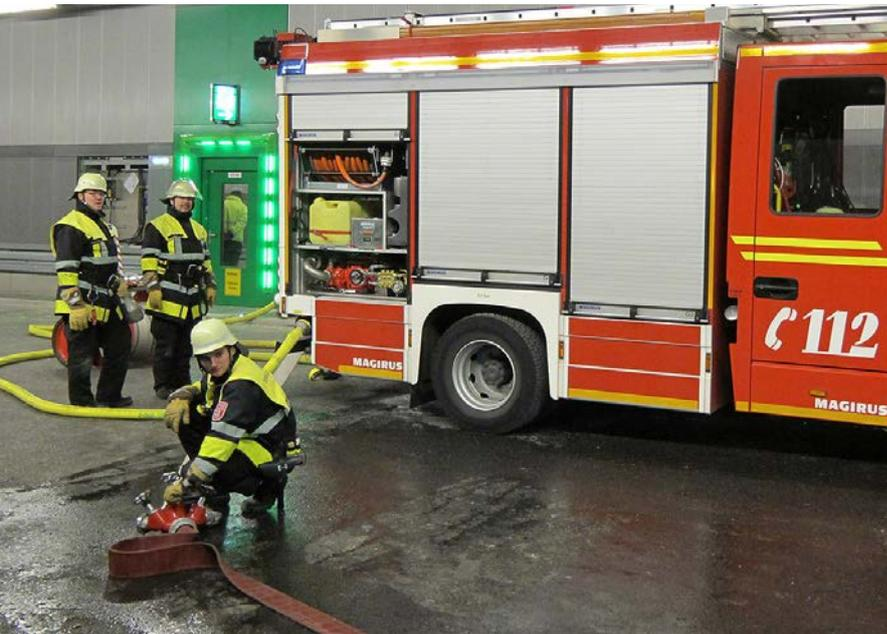
Einspeisung von Löschwasser für das Hilfeleistungslöschfahrzeug
