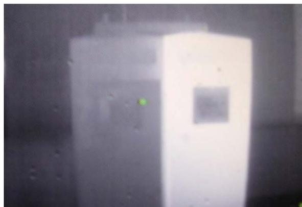
Derselbe Postbriefkasten durch die Wärmebildkamera gesehen. Durch die helle Darstellung gut zu erkennen ist die Erwärmung auf der rechten Seite.
