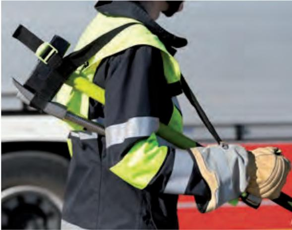
Bei Feuerwehren mittlerweile weit verbreitet ist das Universalwerkzeug zum Öffnen von Türen und Metallflächen: das Halligan-Tool.
