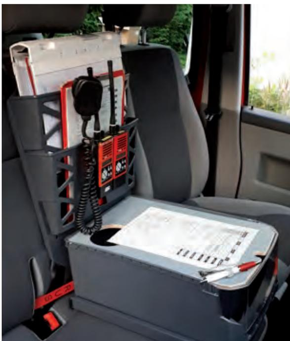
Wenn das Mehrzweckfahrzeug als Führungsfahrzeug eingesetzt wird, ist das Führungspersonal froh, während der Anfahrt komfortabel Notizen machen und auf Unterlagen wie die aus dem Feuerwehr-Informations-Ordner zurückgreifen zu können.
