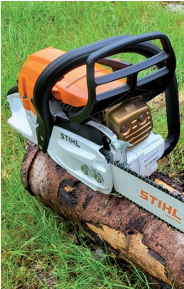
Die Motorkettensäge wird standardmäßig auf allen Hilfeleistungslöschfahrzeugen mitgeführt. Zum Einsatz kommt sie häufig nach Unwettern und Sturm-Wetterlagen, um Straßen und Wege freizuschneiden und Gefahren durch herabfallende Äste zu beseitigen.
